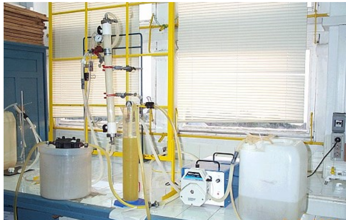
Figura 2 Equipo banco de clarificación con membranas
